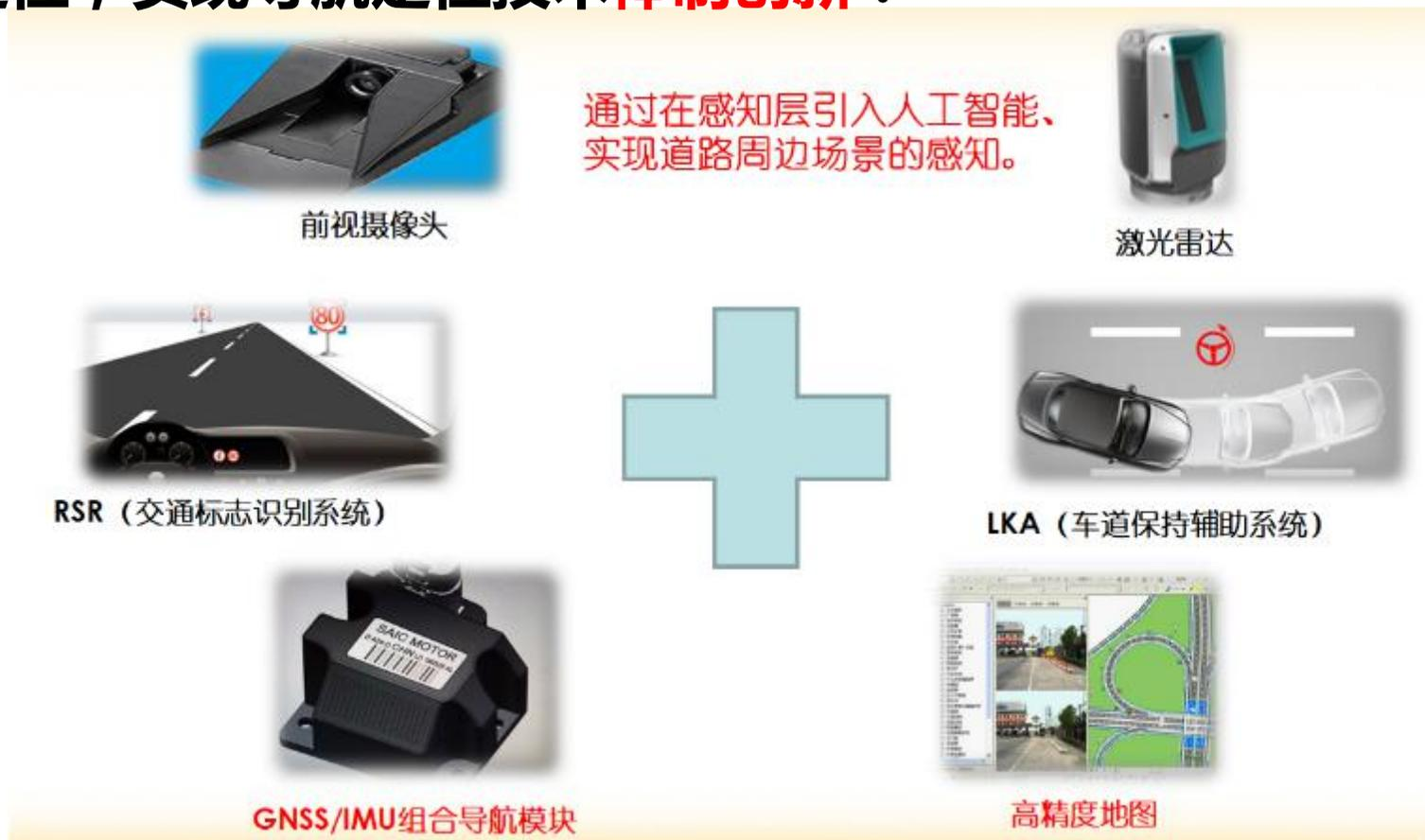
感知传感器+组合导航+高精度地图，实现多传感器融合，实现高可靠、精准定位！成本控制在2000元左右。
